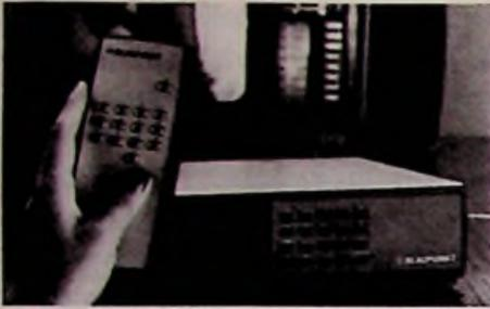
**Bild 1: Der Teilnehmerkonverter „TK 02“ mit IR-Fernbedienung** (Blaupunkt-Pressbild)
